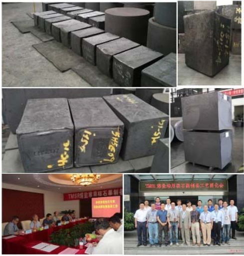
图8 低孔径防熔盐浸渗细颗粒石墨材料400×400×600 mm 工艺见证图片
