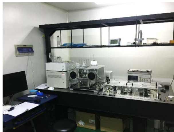
图5 太赫兹时域光谱及成像装置
