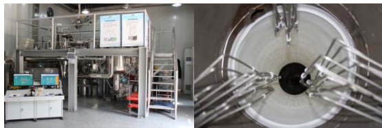
图3 冷冻壁技术实验装置和形成的冷冻壁外观图
