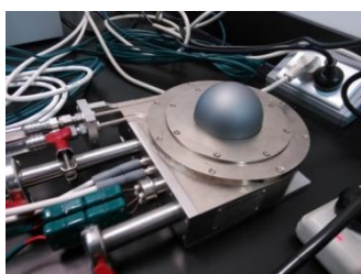
图 6 穹顶铍窗高温热台
