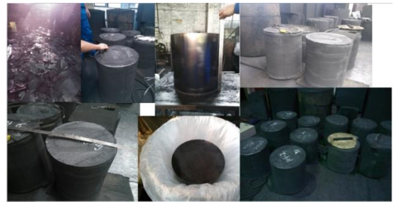
图 10 低孔径防熔盐浸渗细颗粒石墨材料 \Phi 400 \times 400 mm 工艺见证图片
