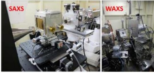
图4 原位变温冷热 GISAXS 实验装置
