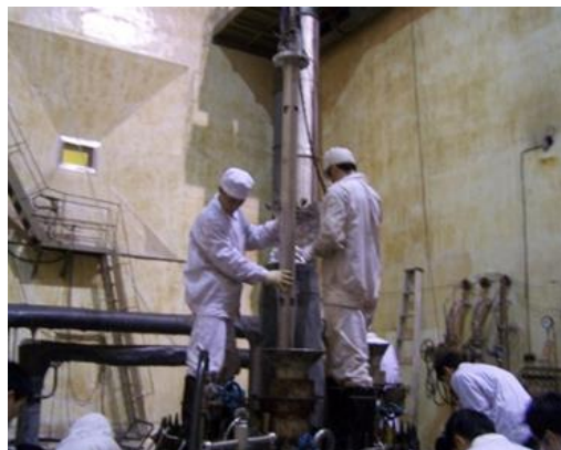
图 6 辐照装置入堆操作
