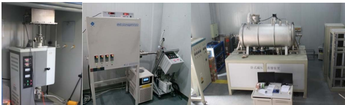
图4 减压蒸馏熔盐回收技术的研究与工艺装置(左:克量级研究装置;中:百克量级研究装置;右:千克级工艺研究装置)
