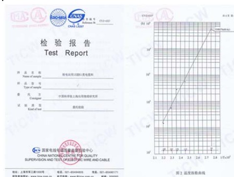
图 4 60 a 核电电缆料热寿命评定报告(部分)
