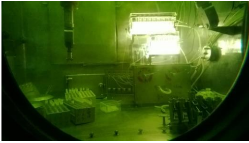
图2 热室内运行中的 233 U提取示踪试验台架
