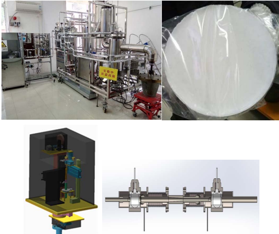
图2 5 kg 级熔盐制备样机（上左）及 FLiNaK 熔盐产品照片（上右）在线取样样机 3D 设计图（下左）和熔盐转运阀设计图（下右）
