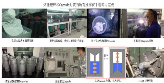
图 1 静态浸泡腐蚀流程
