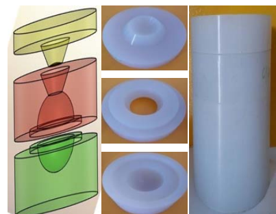
图 4 硅橡胶模具设计效果图和实物照片
