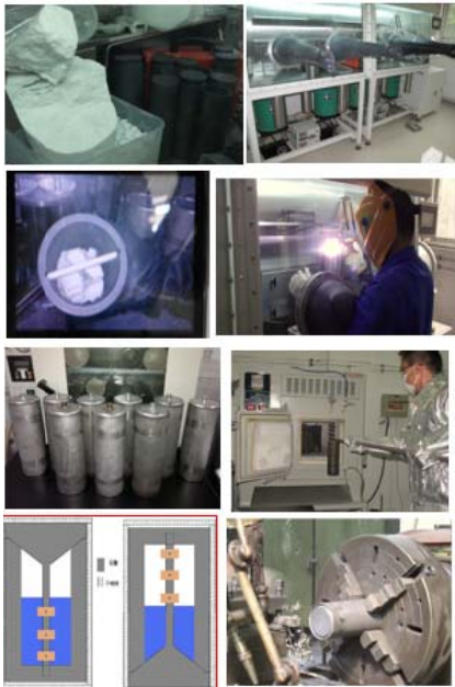
静态腐蚀测试平台与测试流程(排 1 左: 盐锭&盐块&石墨容器; 排 1 右: 用于熔盐破碎、烘烤、封装的手套箱; 排 2 左: 装好盐块和样品的 Capsule; 排 2 右: 手套箱内 Capsule 焊接; 排 3 左: 准备加热腐蚀的 Capsules; 排 3 右: 高温取出 Capsule; 排 4 左: 高温 Capsule 倒置, 样品脱盐; 排 4 右: Capsule 切割)
