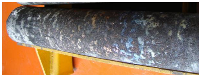
图 1 直径 360 mm 合金 GH3535 自耗锭
