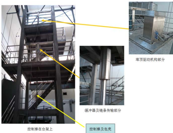
图 1 控制棒驱动机构原理样机装置
