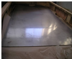
图 2 合金 GH3535 冷轧板(4 mm×950 mm×2000 mm)
