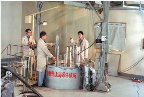
图 1 728 工程石墨-熔盐零功率装置
