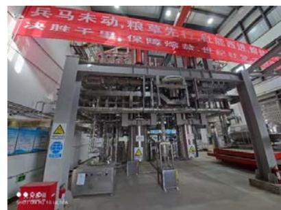
图 4 百公斤级氟化物熔盐制备净化中试装置图
