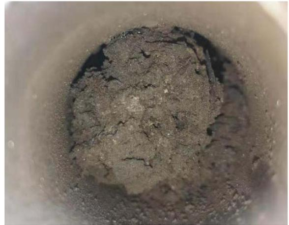
图7 腐蚀产物在冷端沉积造成管道堵塞
