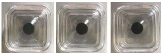
图3 从左至右: UO<sub>2</sub>-Zr, UO<sub>2</sub>-SiC, UO<sub>2</sub>-纳米金刚石复合芯块
