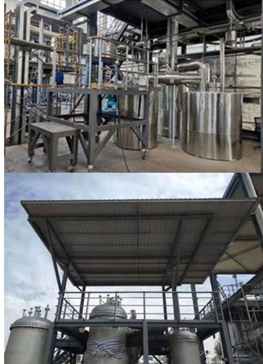
图 3 氯化物熔盐制备净化中试生产线装置图（上：百公斤级装置；下：吨级装置）
