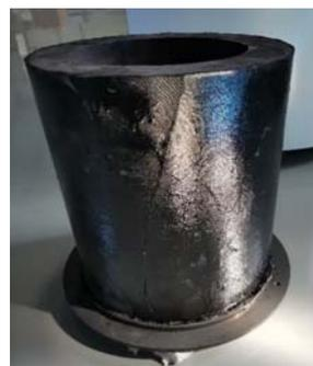
图 10 用于高温熔盐存储石墨储罐
