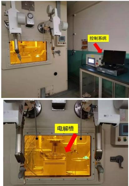
图2 热室内熔盐电解法分离钍铀实验装置
