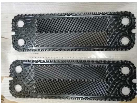
图 8 熔盐热处理后的不锈钢换热片
