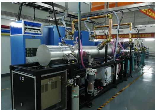
图 2 进口自美国 ACCSYS 公司的直线注入器
