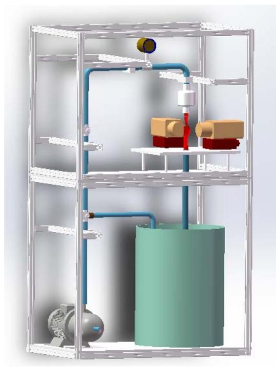
图 2 液态锂靶模拟回路
