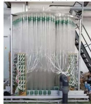
图 1 堆芯流量分配试验模型
