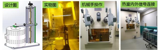
图4 热室内电化学装置机械手操作和内外通讯实验验证
