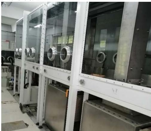
图 7 卤化物熔盐热处理系统。
