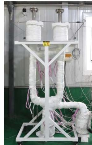
图 2 自主研发的自然循环动态腐蚀装置
