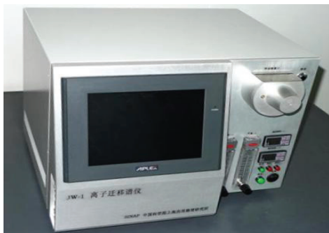
图 2 基于工控机的一体化 IMS 检测平台
